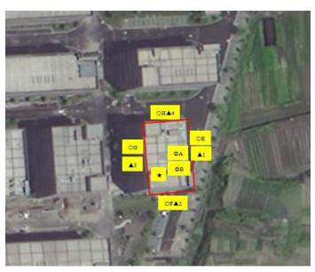
注:★为废水采样点,◎为有组织废气采样点,○为无组织废气采样点,▲为噪声监测点。
