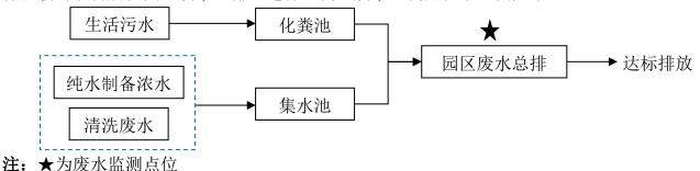
图 3-1 项目废水处理流程示意图
